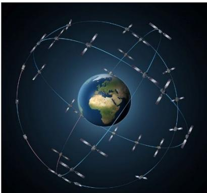
Figure 5 : Exemple de la constellation de satellites issue du système européen Galileo en orbite moyenne. Galileo utilise plusieurs satellites pour une plus large couverture des différentes parties du globe<sup>95</sup>.
